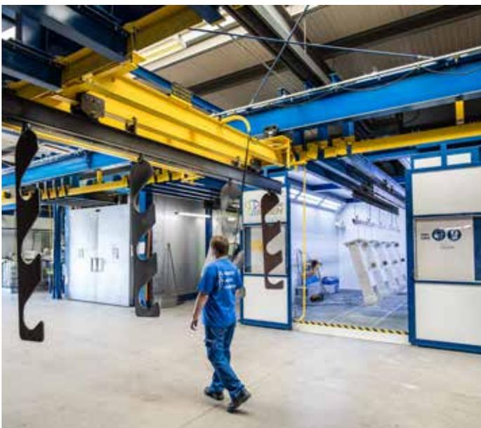
Eigene Pulverbeschichtungsanlage – für eine makellose Oberfläche
