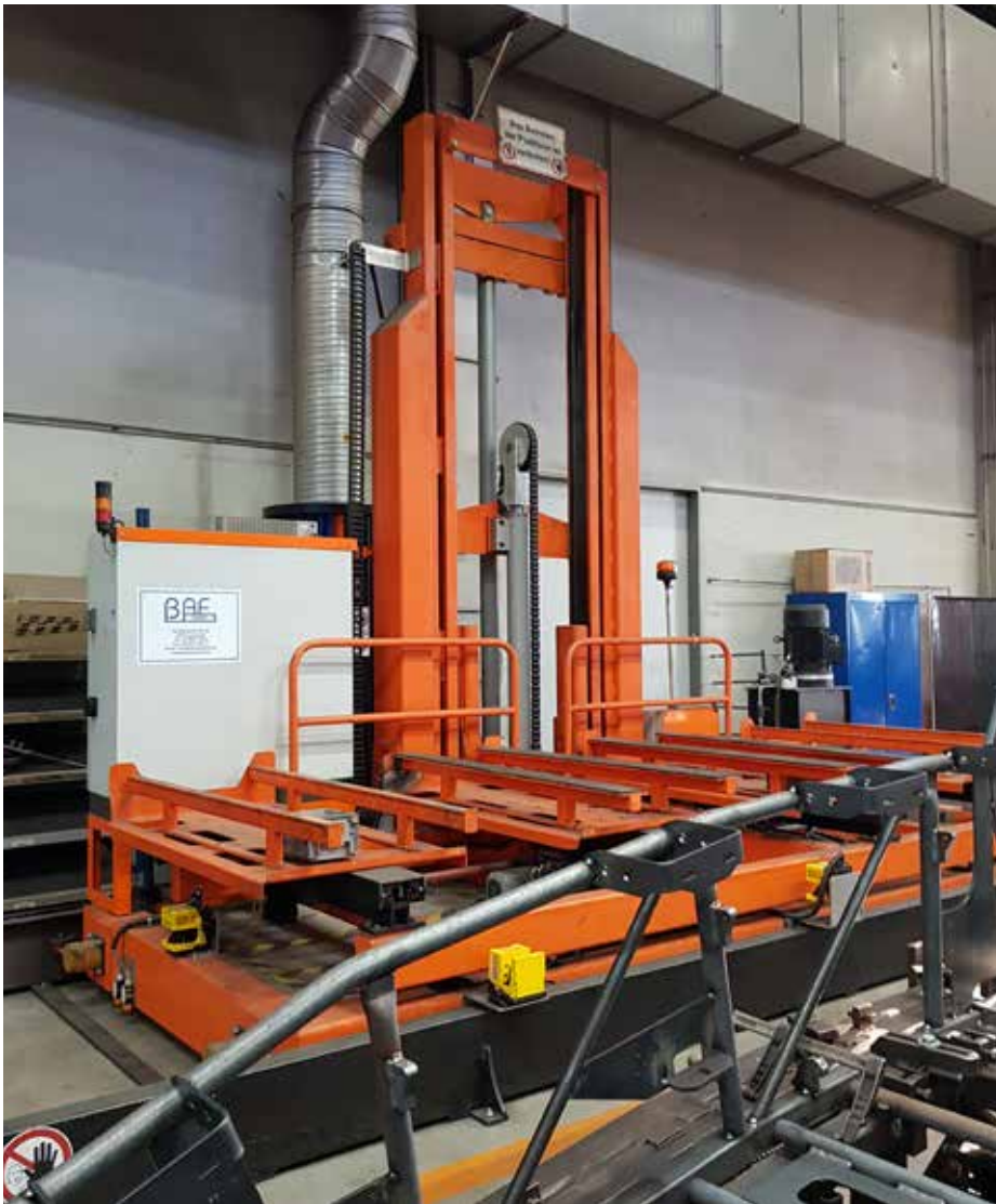
Verfahrgagen mit 7 m Hub und 4 Teleskopgabeln für lange Teile für Baumaschinenhersteller
