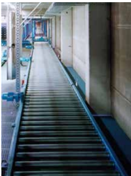
1,2 km lange Förderstrecke mit allen Förderelementen bei Getränkehersteller
